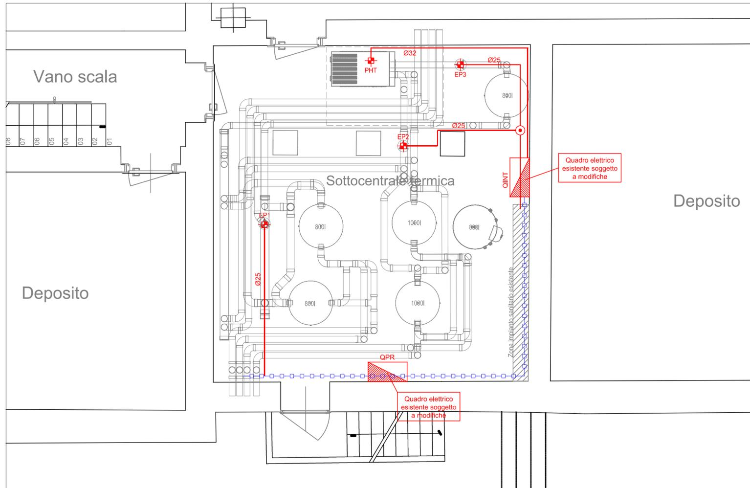
DETTAGLIO PIANTE DISTRIBUZIONE IMPIANTO NELLA SOTTOCENTRALE TERMICA - SCALA 1:50
