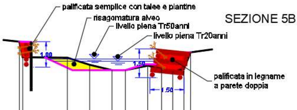
Figura 2-30 – Sezione tipo alveo. (rappresentazione non in scala)
