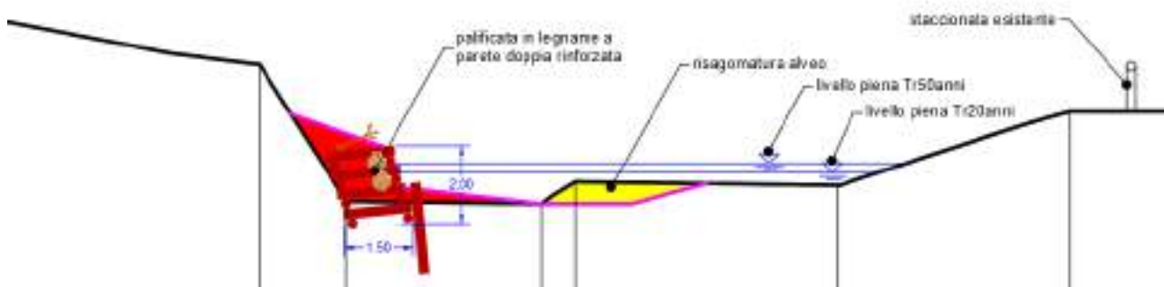
Figura 16 – Sezione tipo alveo. (rappresentazione non in scala)
