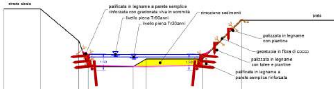
Figura 3 – Sezione tipo. (rappresentazione non in scala)
