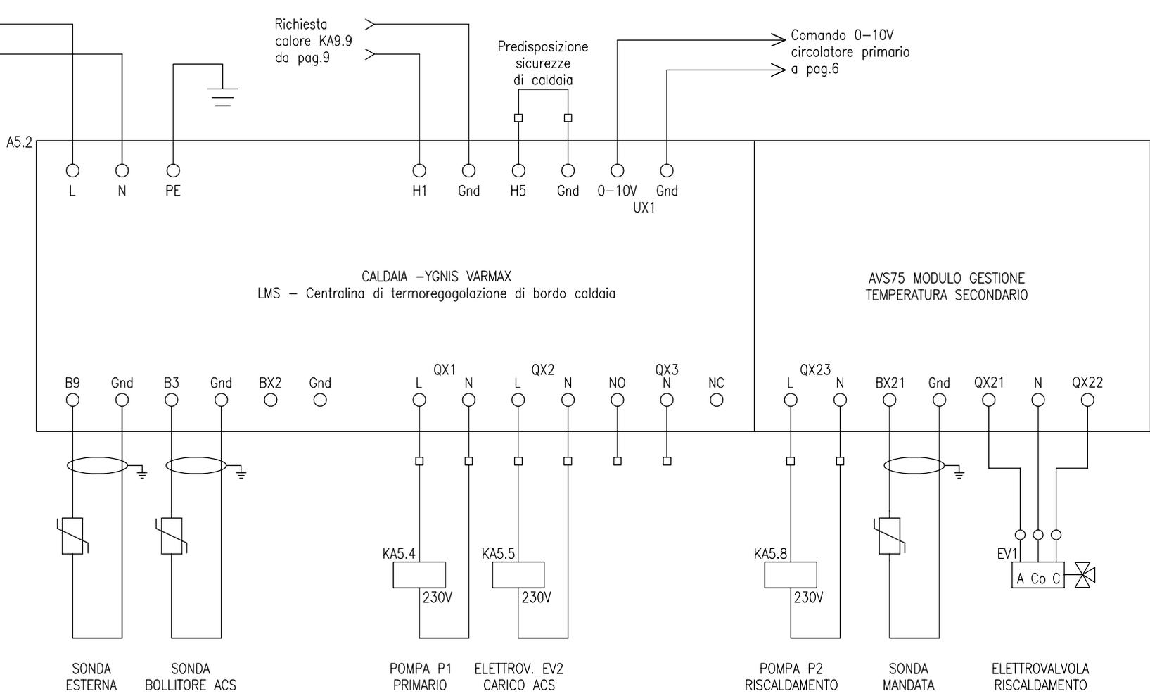
In ottemperanza a quanto richiesto dall'art. 7.1 della raccolta R Inail del 2009 è necessario che il regolatore sia programmato in modo tale che l'accensione del bruciatore sia subordinata al comando di avvio della pompa del primario.
