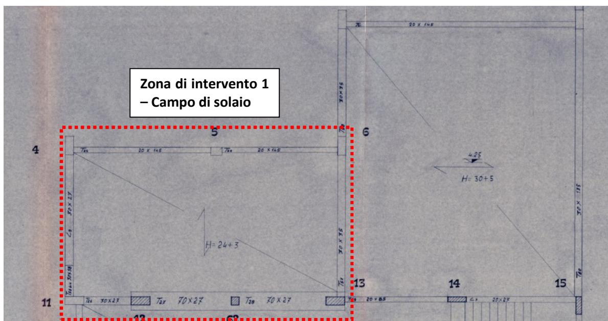
Figura 2 – Individuazione del campo di solaio oggetto di verifica al piano primo dello stabile individuate sulle nelle carpenterie originarie.
