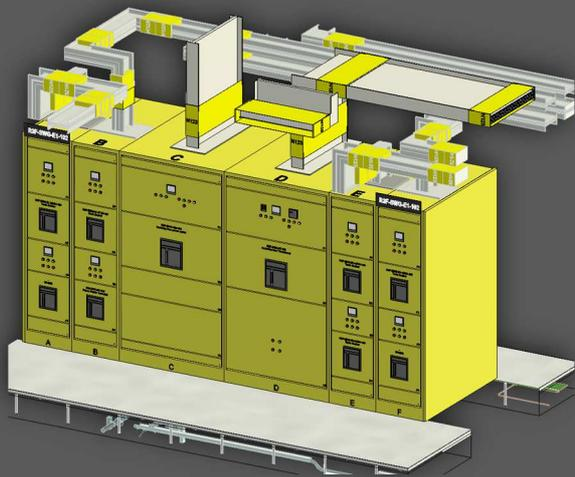
**Quadro elettrico di distribuzione** con riportate tutte le informazioni degli elementi costituenti l'impianto per una corretta e rapida installazione da parte dell'appaltatore.
