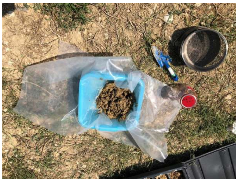
Figura 3-2 -Setacciatura dei terreni da campionare
