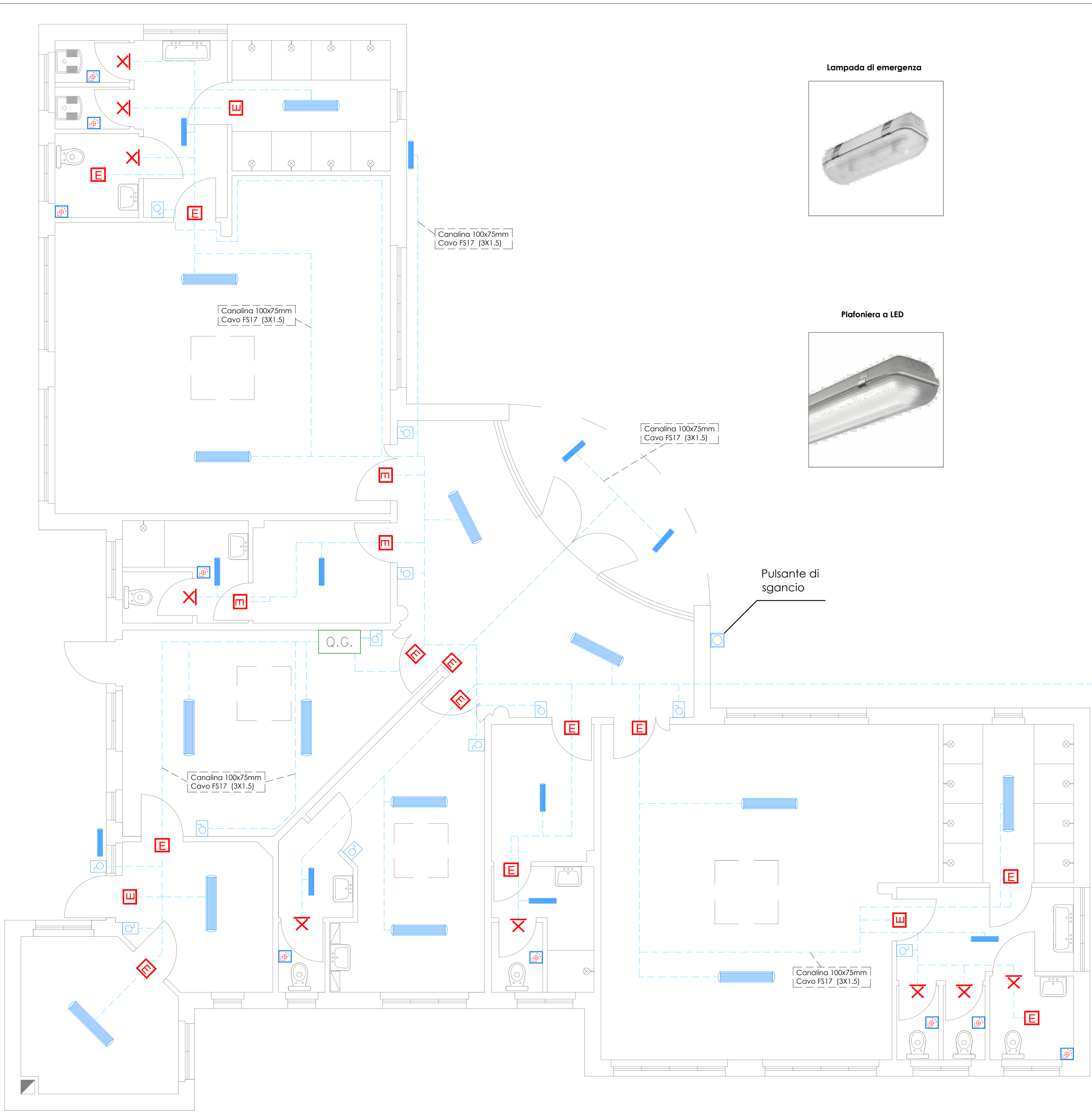
PIANTA IMPIANTI ELETTRICO LUCE ED ILLUMINAZIONE D'EMERGENZA PIANO TERRA scala 1:50
