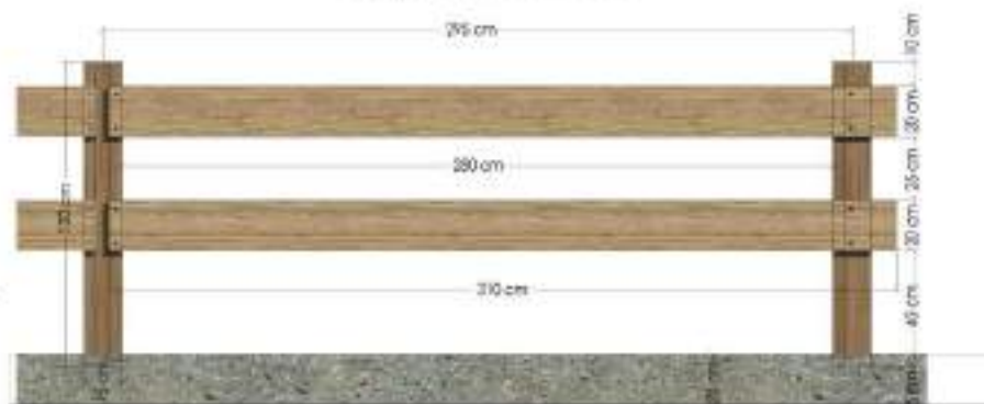
Prospetto della staccionata
