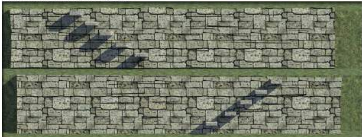
Tipologia di muro a secco con gradini aggettanti
