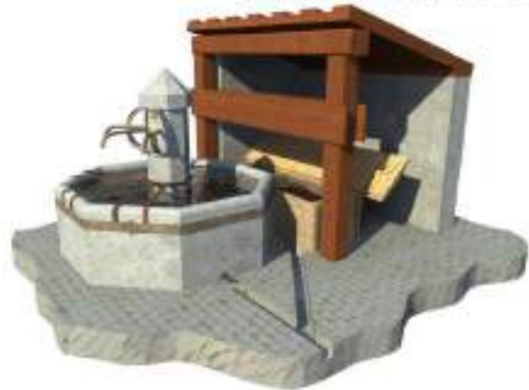
Tipologia di fontana esagonale in pietra a colonna centrale con lavatoio annesso
