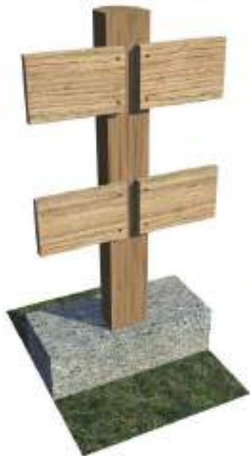
Particolare del punto di incastro del montante al basamento
